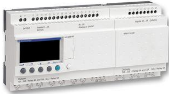
Şəkil 2. Zelio Soft İdarəetmə qurğusu SR2A201FU
