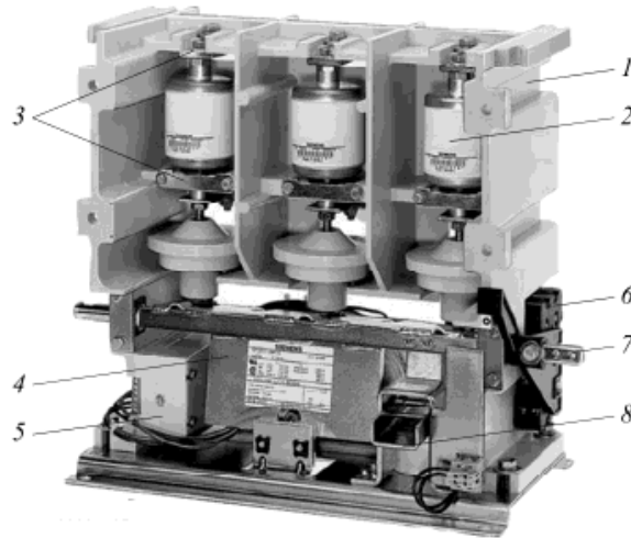
Şəkil 5. Areva T&D (Fransa) firmasının vakuumlu kontaktoru 1 – gövdə; 2 – vakuumlu kameralar; 3 – terminallar; 4 – elektromaqnit intiqal; 5 – idarəetmə sistemi; 6 – köməkçi blok-kontaklar; 7 – val; 8 – mexaniki cəftə
